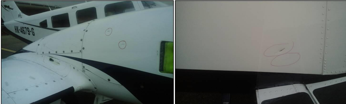
Fotografías No. 4 y No. 5 - Daños en el plano/nacela del motor izquierdo y fuselaje
