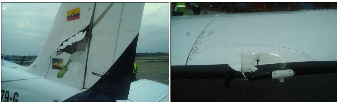
Fotografías No. 6 y No. 7 - Daños en el estabilizador vertical y borde de ataque del plano derecho
