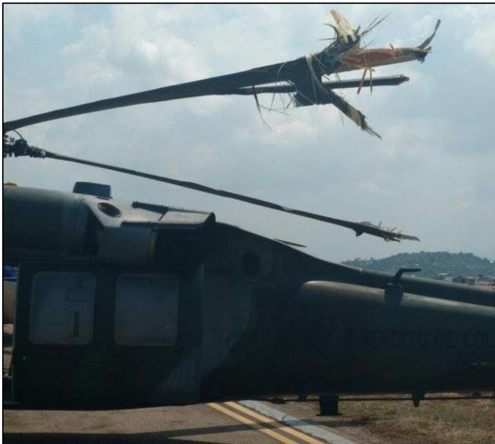
Fotografía No. 2 - Daños en las palas del rotor principal del helicóptero UH-60L
